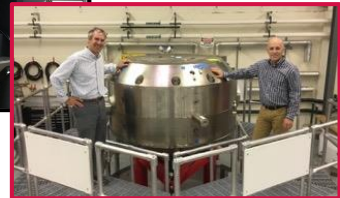
Mevion – 15 Ton Synchrocyclotron
